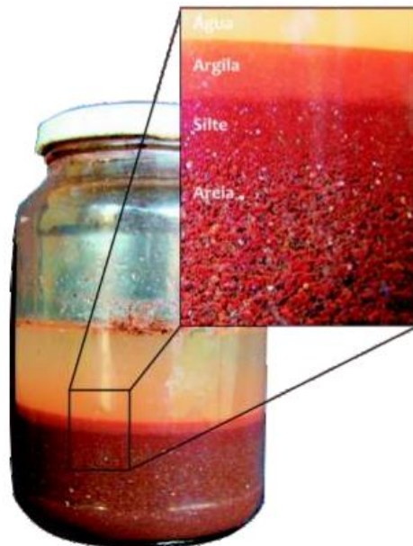
Figura 1: Ensaio prático para comparar os solos em relação a composição granulométrica 7
