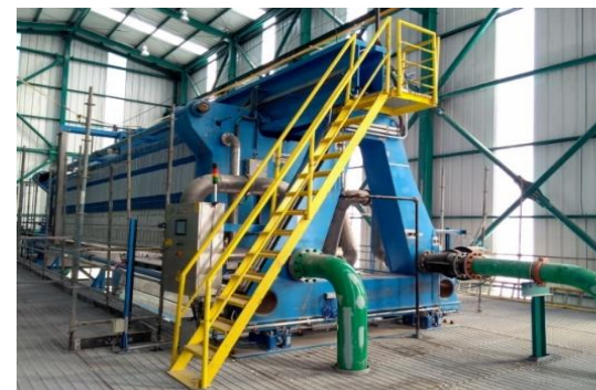
Filtro Prensa: equipamento utilizado no desaguamento de rejeitos de mineração. Fonte: blog Conexãomineral.com
